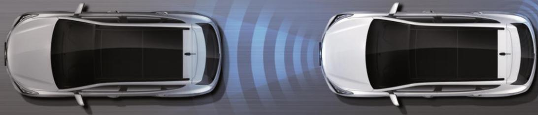
Система автоматического экстренного торможения
